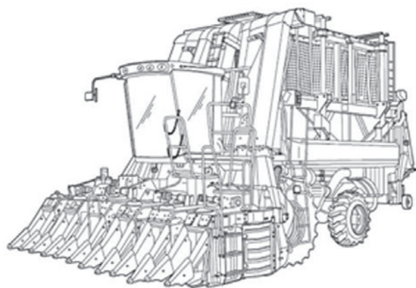
Colhedora de café: equipamento agrícola automotriz que efetua a "derrida" e a colheita de café.
